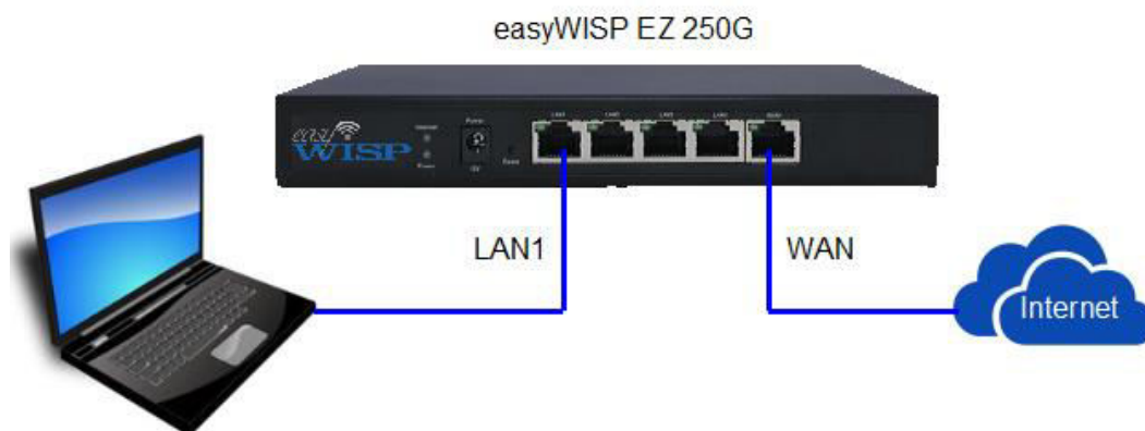
Figura 9.7.1. Conecte una computadora para configurar el enrutador de control de acceso easyWISP.
