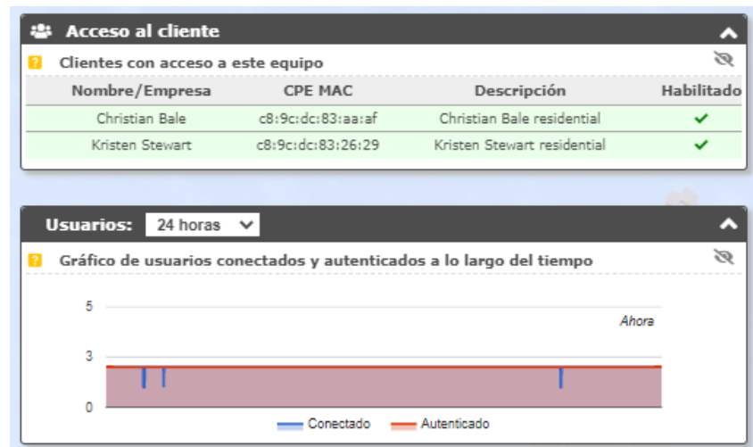
Figura 9.17.4. La lista de suscriptores asociados con la puerta de enlace del enrutador de control de acceso de la torre y un gráfico que muestra la cantidad de suscriptores autenticados con el tiempo. El eje de tiempo se puede seleccionar entre 1 hora y 1 semana.
