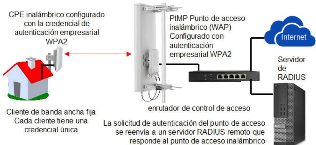
Figura 3.3.3. Autenticación WPA2-enterprise del cliente mediante el protocolo RADIUS.
