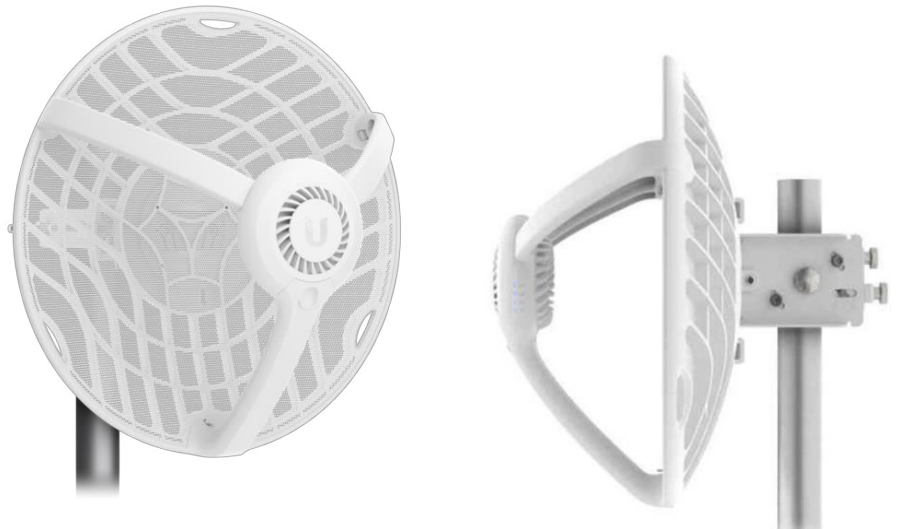
Figura 2.10.4. Punto de acceso inalámbrico con antena para la banda sin licencia de 61GHz. (Ubiquiti airFiber 60 LR. © Ubiquiti). La distancia máxima de transmisión es de 12Km.
