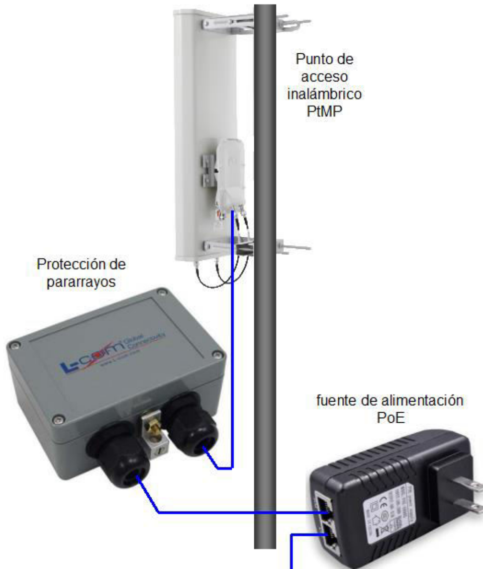
Figura 2.14.2. Cable de datos Ethernet Supresor de rayos.
