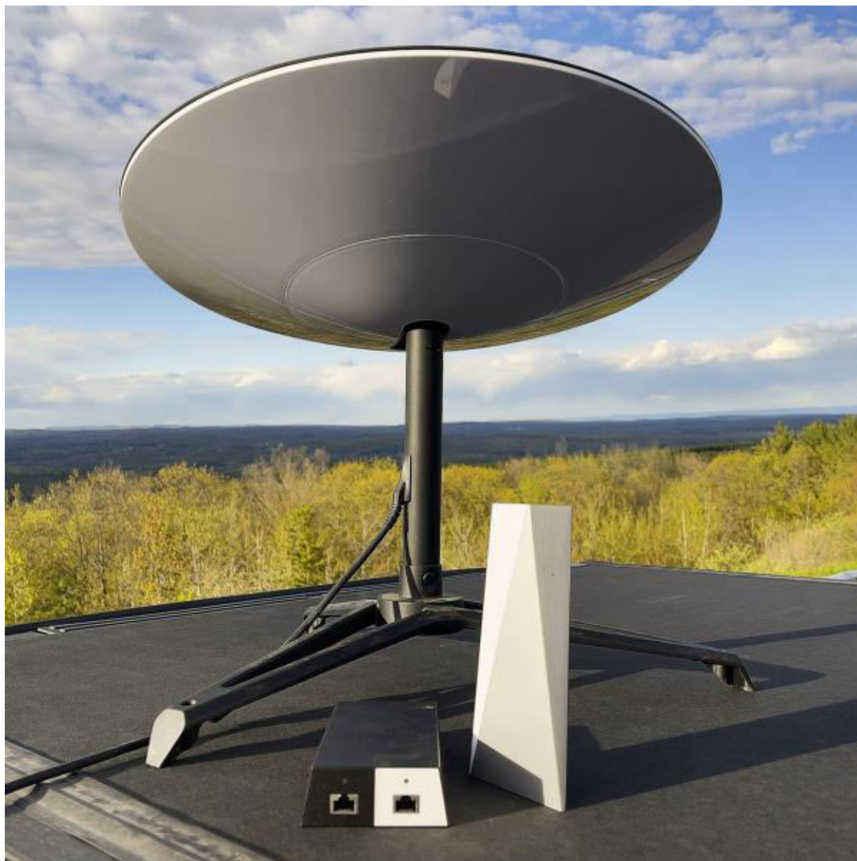
Figura 8.3.5. Antena de cliente Starlink con enrutador inalámbrico e inyector PoE (Imagen con derechos de autor © SpaceX 2021).
