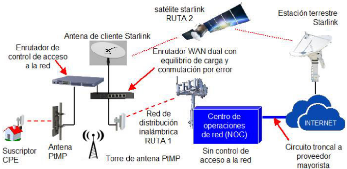
Figura 8.4.3. Antena satelital LEO instalada en la torre PtMP con control de acceso en la torre con balance de carga dual WAN y failover.
