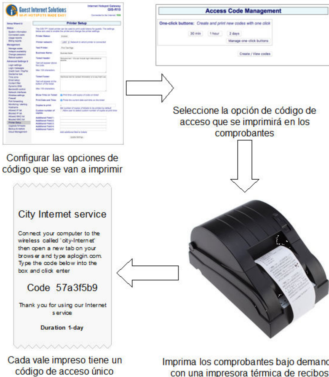
Figura 3.14.2: El proceso para imprimir comprobantes utilizando una impresora térmica de recibos.
