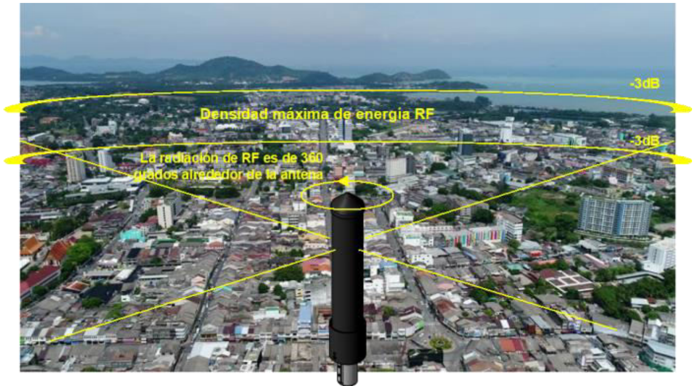
Figura 2.8.6. Intensidad del campo de radiación de la antena omnidireccional inclinada hacia abajo.
