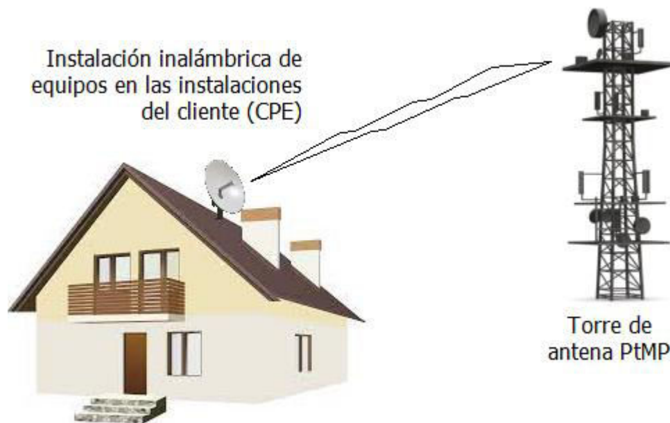
Figura 2.9.1. Instalación de la antena del equipo local del cliente.
