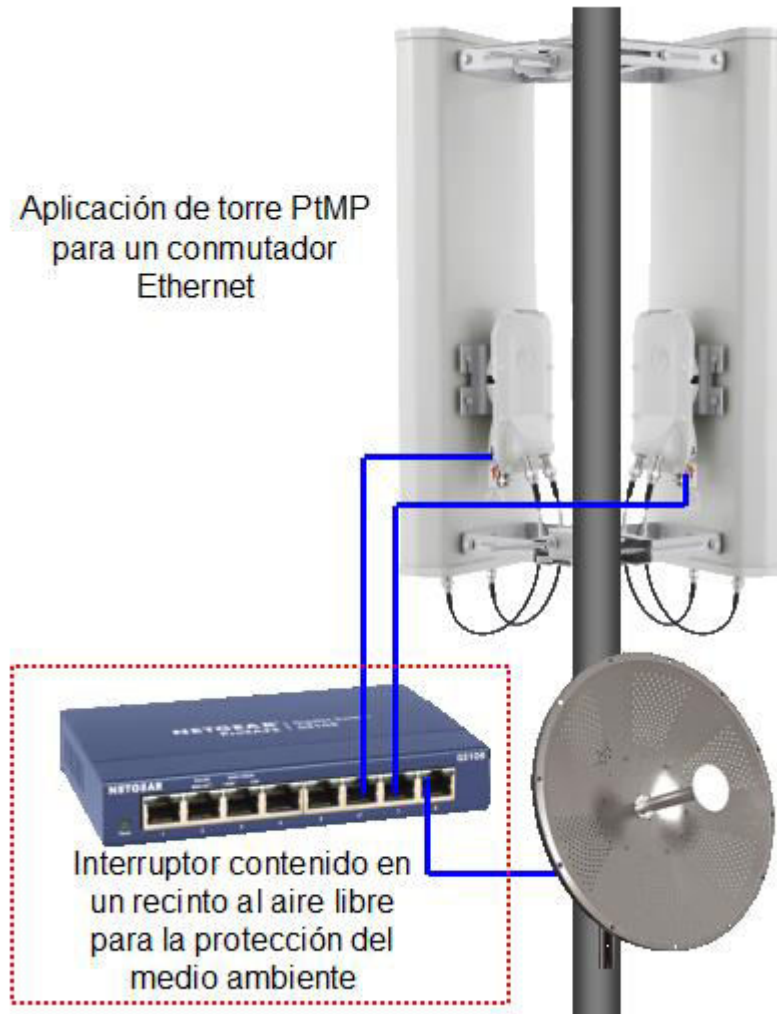
Figura 2.12.3. Aplicación de un switch Ethernet instalado en una torre PtMP.
