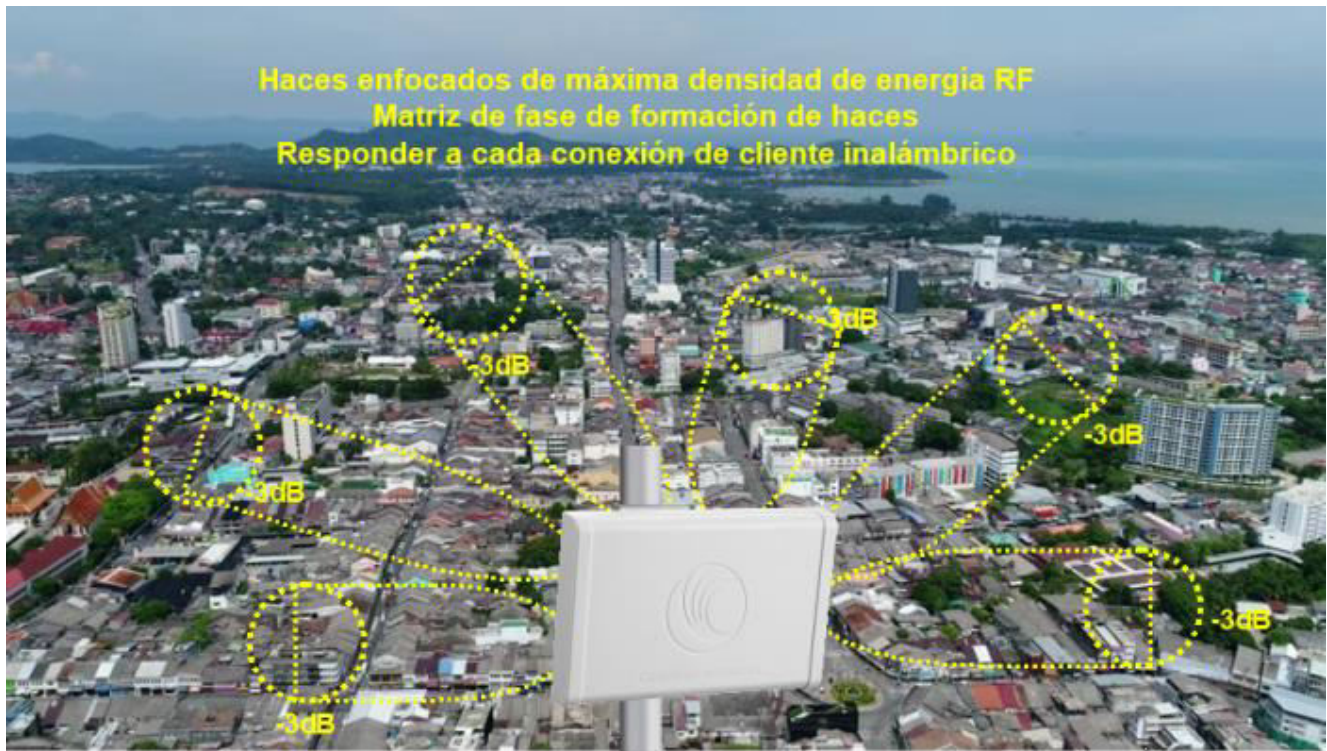
Figura 2.8.16. Intensidad del campo de radiación de la antena formadora de haces.
