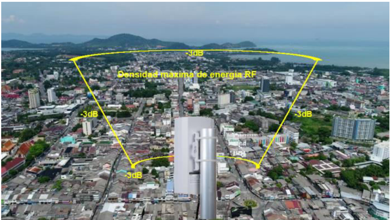
Figura 2.8.9. Intensidad del campo de radiación de la antena direccional del panel.
