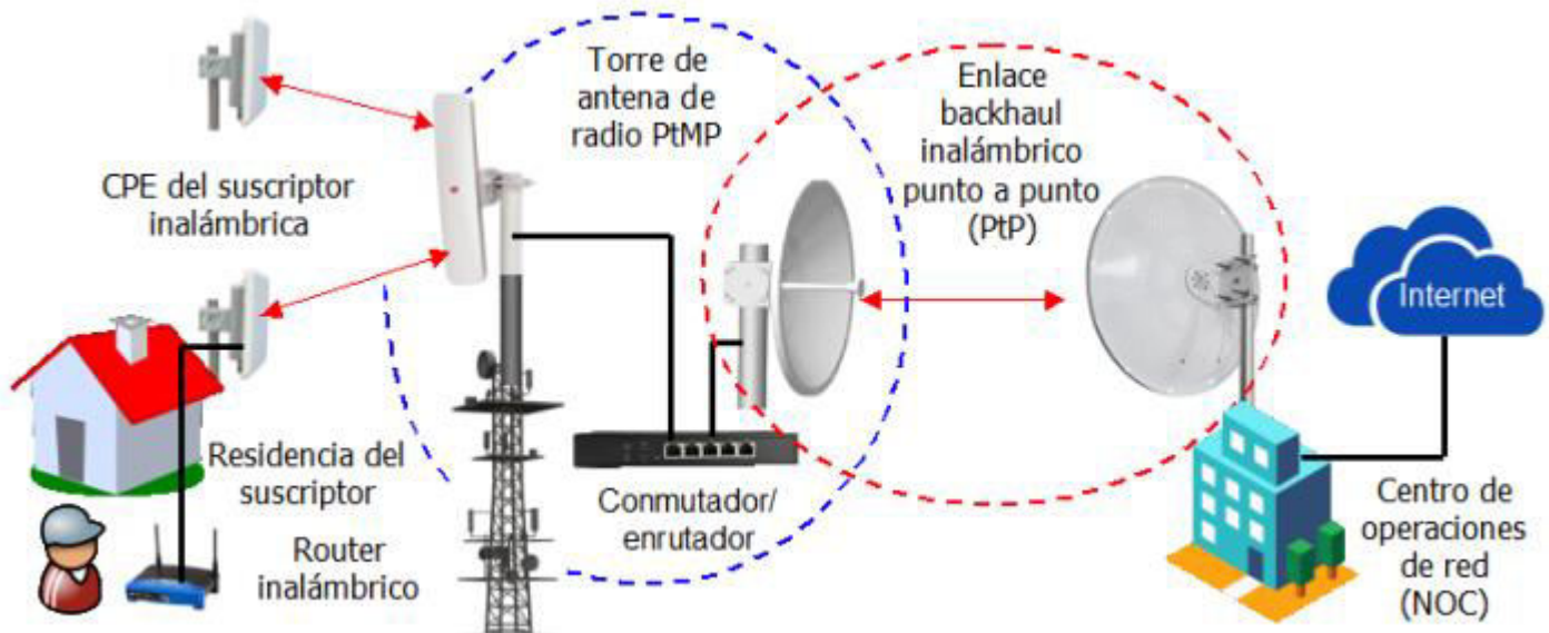
Figura 2.10.1. Enlace backhaul inalámbrico punto a punto desde la torre PtMP al centro de operaciones de red (NOC) del ISP
