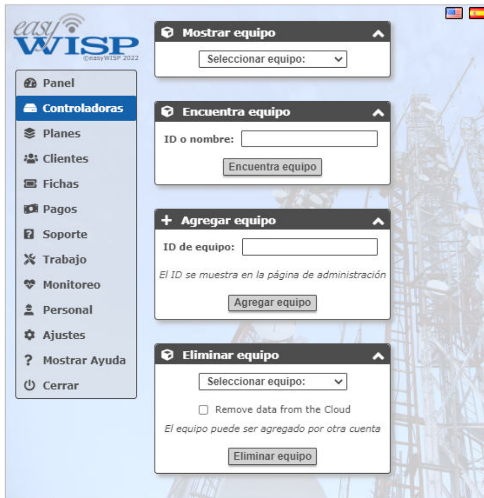
Figura 9.21.1. Haga clic en la entrada del menú de la puerta de enlace para agregar una nueva ID de puerta de enlace del enrutador de control de acceso y luego seleccione la puerta de enlace para la configuración.
